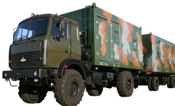
Рисунок 8. – Подвижной радиотелевизионный центр ПРТЦ-2007
