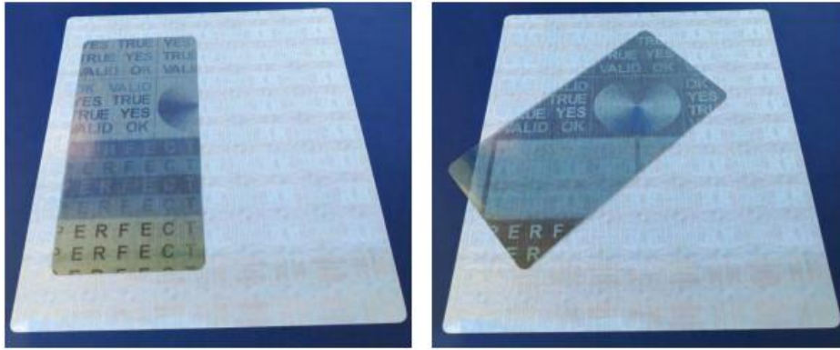
Рисунок 2. – Примеры визуализации скрытого изображения в монохромной кристаллограмме с помощью поляризационного фильтра
