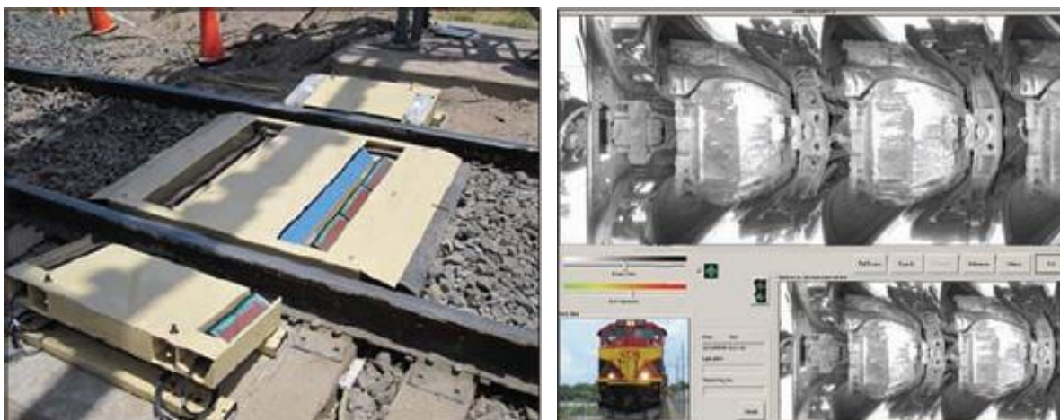
Рисунок 4. – Модификация комплекса Gatekeeper для автоматического досмотра днища железнодорожного транспорта
