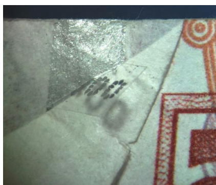
Рисунок 3. – Имитация защитной нити с использованием белого тонера
