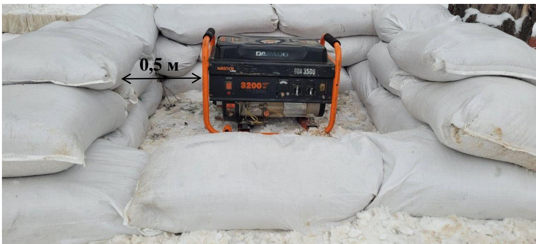
Рисунок 1. – Вариант размещения бензогенератора на позиции
