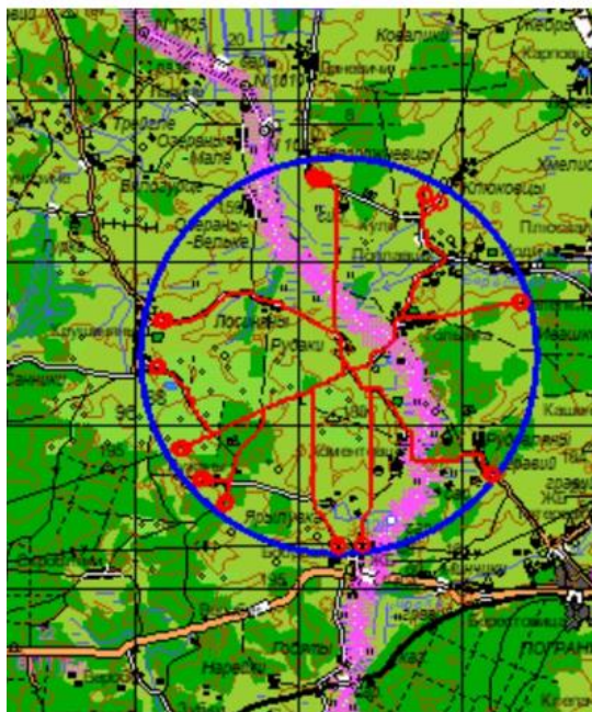
Рисунок. – Результат работы модифицированного алгоритма Дейкстры при реализации алгоритма моделирования вероятного движения нарушителя
