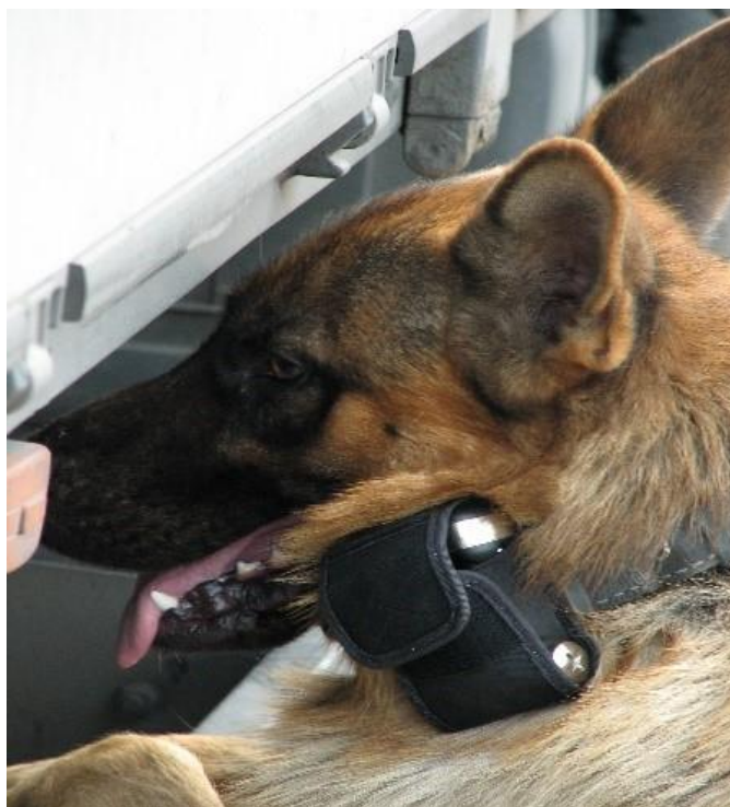
Рисунок. – Вариант закрепления технического средства радиационного контроля на ошейнике служебной собаки
