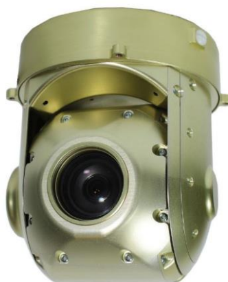
Рисунок 4. – Гиросtabilизированная оптико-электронная система телевизионная
