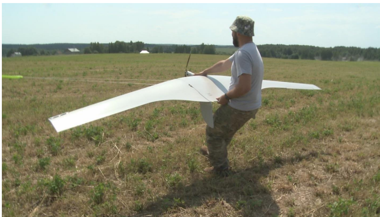
Рисунок 2. – Беспилотный авиационный комплекс тактический малой дальности «Беркут-3Э»
