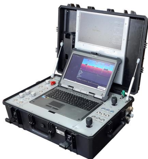
Рисунок 6. – Наземная станция управления
