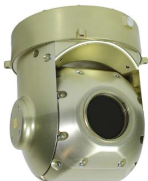
Рисунок 5. – Гиростабилизированная оптико-электронная система тепловизионная
