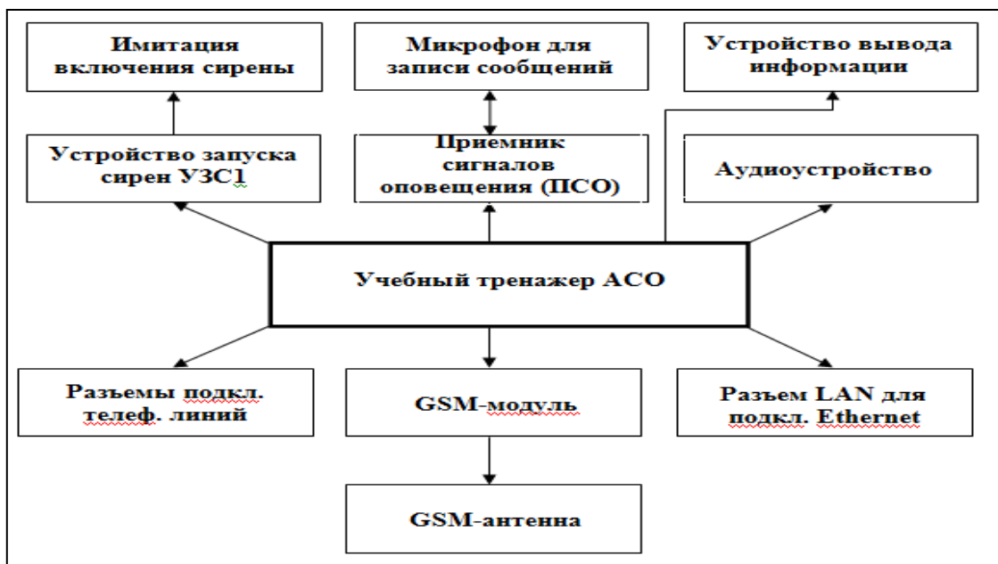
Рисунок 1. – Схема учебного тренажера для отработки навыков работы с КТПС АСО системы ГСЧС и ГО
