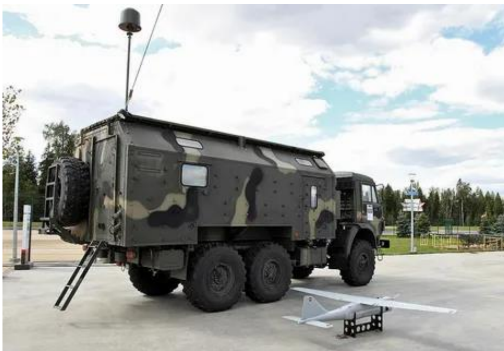
Рисунок. – Комплекс подавления GSM-связи «Леер-3» с БПЛА «Орлан-10»
